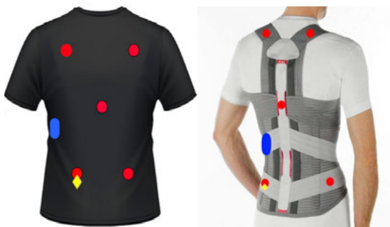
Рис. 2. Расположение датчиков, где красный цвет – гироскоп, желтый – пульсометр, синий – микроконтроллер с аккумулятором
