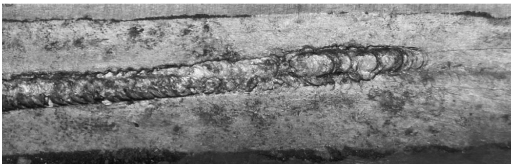
Рисунок 6. Инородные включения от подложки в корне шва при СТП разнородных металлов
