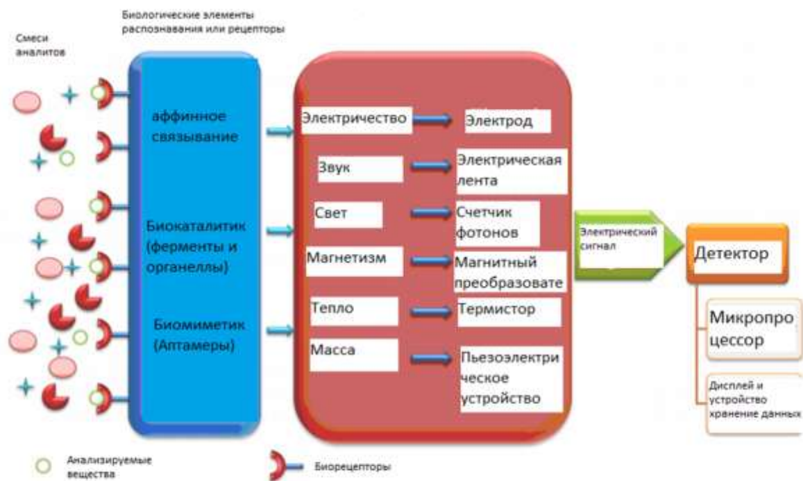
Рисунок 1. Иллюстрация трех основных компонентов биосенсора: биологические элементы распознавания, преобразователь и детектор
