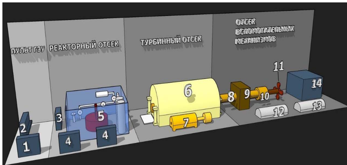
Рис. 1. Перспективный учебно-тренировочный комплекс подготовки специалистов по эксплуатации корабельных ЯЭУ: 1 – рабочее место преподавателя; 2 – пульт управления ГЭУ; 3 – стойки системы автоматического управления; 4 – щиты электроэнергетической системы; 5 – аппаратная выгородка с системами и механизмами паропроизводящей установки; 6 – главный турбозубчатый агрегат; 7 – турбогенератор; 8 – валопровод; 9 – главный упорный подшипник; 10 – уплотнение линии вала; 11 – гребной винт; 12 – компрессор воздуха высокого давления; 13 – дизель-генератор; 14 – водоопреснительная установка.
