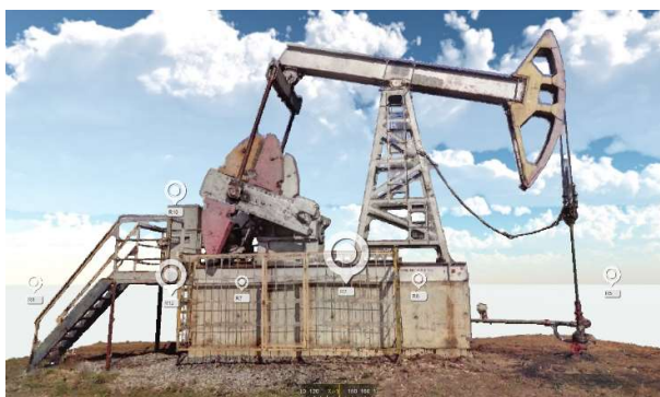
Рисунок 2 – Трехмерная модель станка-качалки
