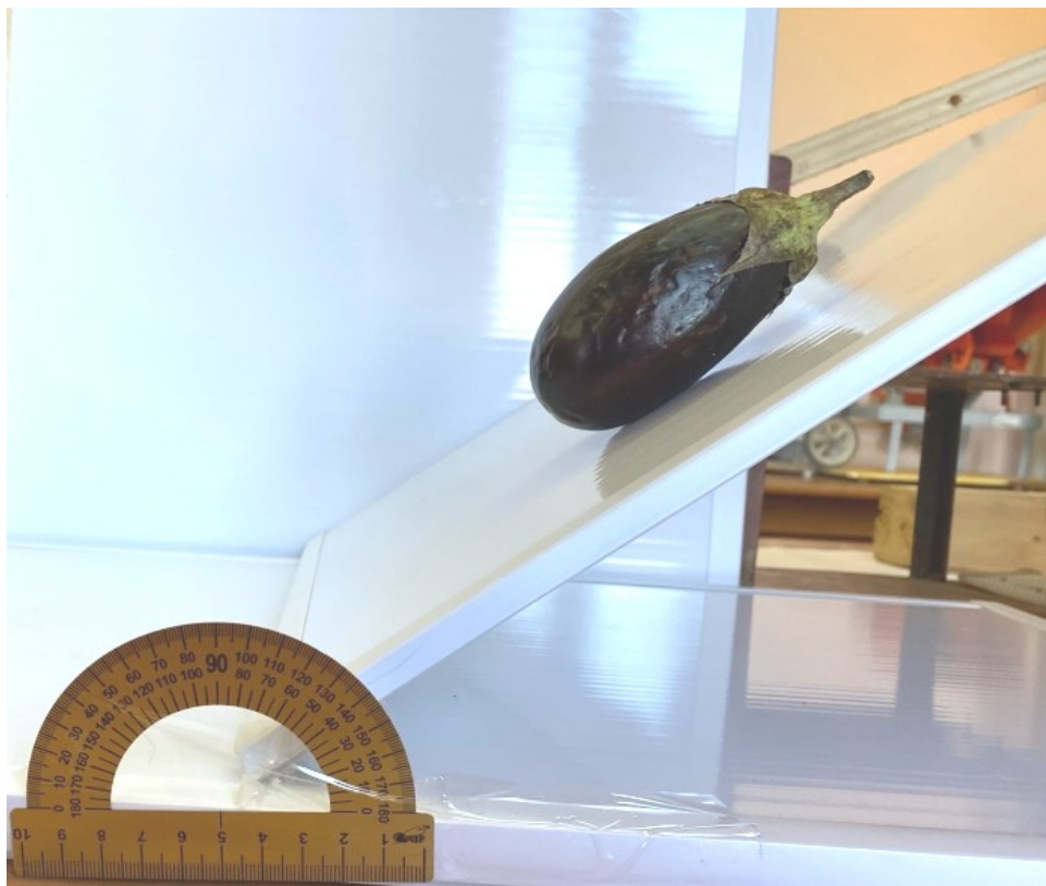
Рисунок 2. Определение коэффициента трения скольжения баклажана
