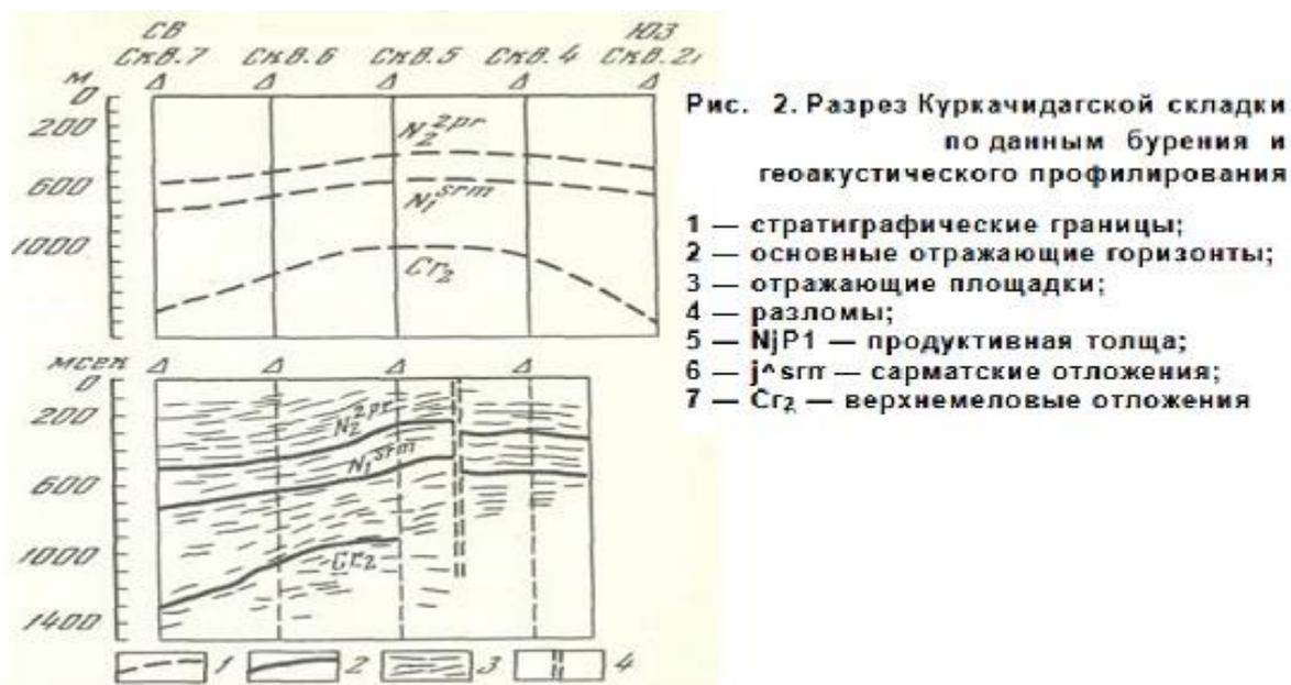
Рис. 2. Разрез Куркачидагской складки по данным бурения и геоакустического профилирования
